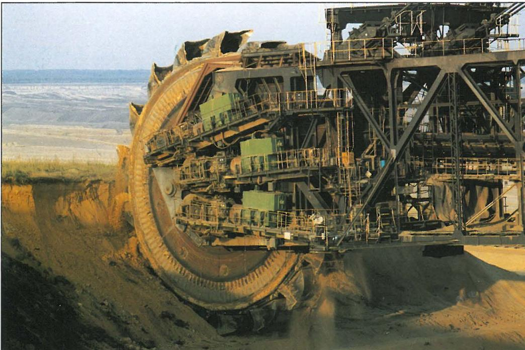
*LAUBAG Tagebau Nochten, pohon lopatkového kola SRs 6300 osazený se 3 přístroji ELHY, typ EB 320/100 c320 SZm*
